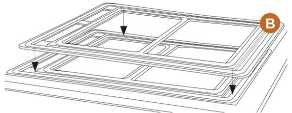
Luego, coloca el segundo componente de la mosquitera puerta por el otro lado de la malla. Presiona hacia abajo hasta sentir que hacen clic. Asegúrate de que todas los tacos vengan con los clips. Para una mejor fijación de la mosquitera puerta, se puede usar pegamento en ambos componentes.
