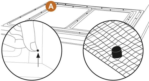
Seleccione el componente de la mosquitera puerta con las inserciones salientes. Colóquelo en la mosquitera puerta de una manera para que todos los terminales pasen a través de la malla que tiene la mosquitera.
